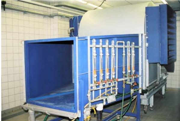
Abbildung 1 Schlagregenversuchsstand
