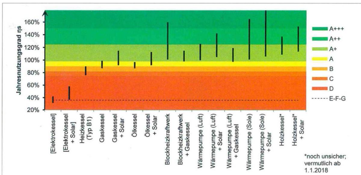
Erwartete Einstufung von Heizgeräten in die Energieverbrauchskennzeichnung nach Verordnung 2013/811/EU als Verbundanlage ab 26. 9. 2015. Bild: UBA
