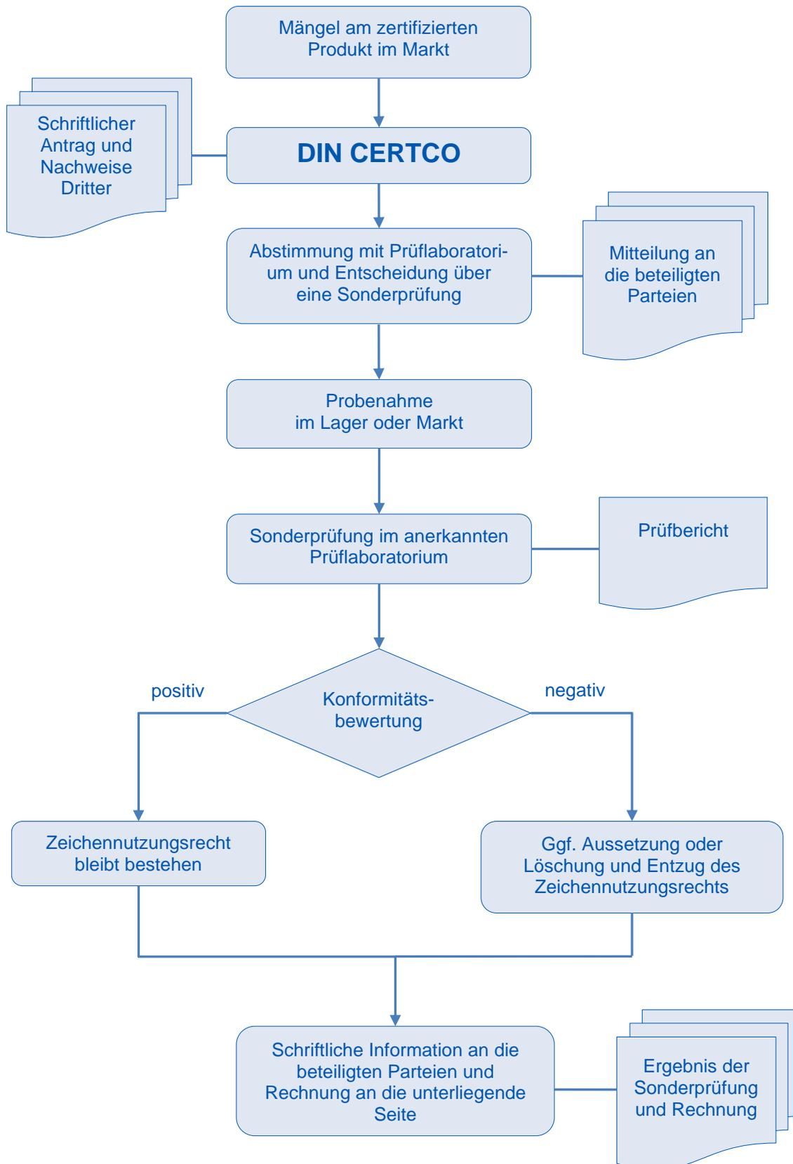
**Abbildung 2** Ablauf Durchführung von Sonderprüfungen
