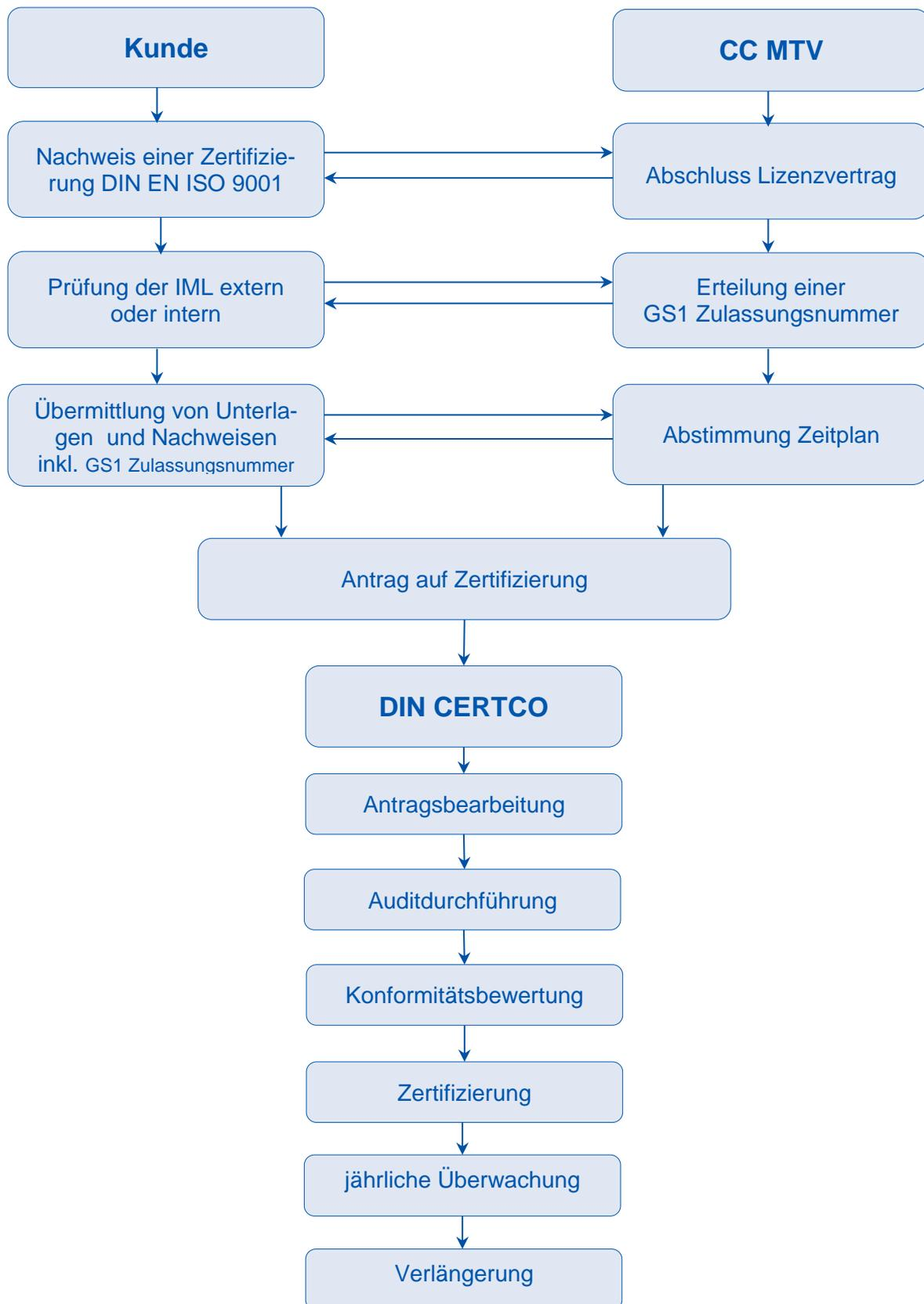
**Abbildung 1** Der Weg zum zertifizierten In-Mould-Label (IML)
