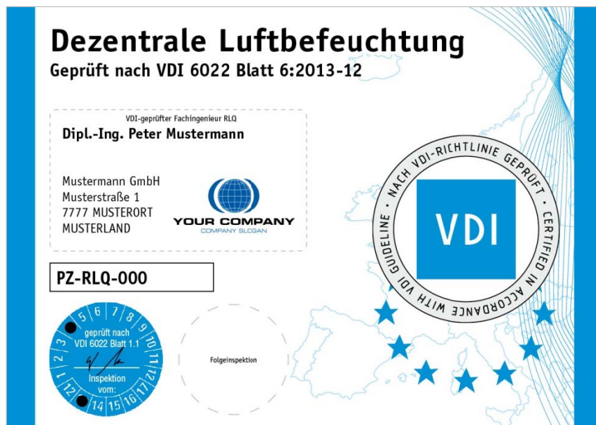
Abbildung 3 Muster-Aufkleber groß zur Kennzeichnung einer dezentralen Luftbefeuchtung
